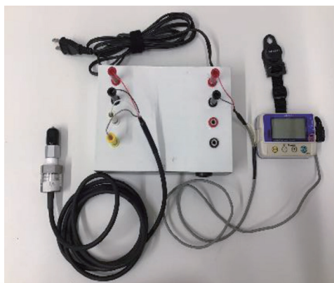
圧縮空気圧力センサーと電圧ロガー
