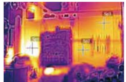
燃焼炉筐体温度分布（高温部 280℃）：表面温度分布を画像で表示できるサーモビューアによる燃焼炉筐体温度分布。
